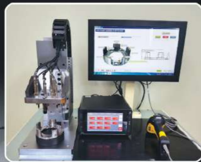
단차 평면도 측정 및 QR코드 바코드 인식
