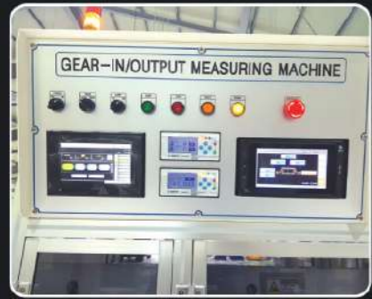
측정기 - 내경은 에어마이크로미터 외경 및 기타 측정은 전자마이크로미터로 측정
