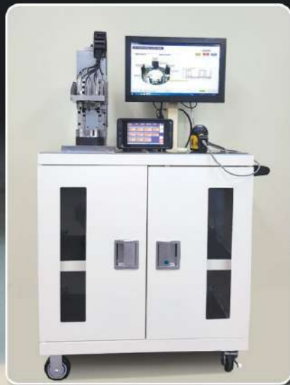
단차 평면도 측정 및 QR코드 바코드 인식
