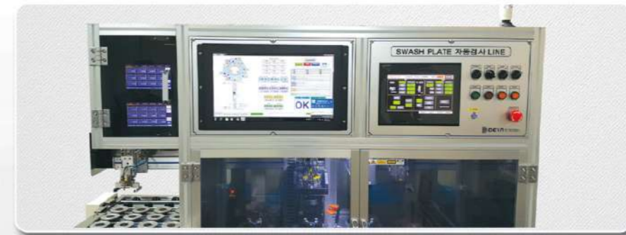
홀유무 두께 단차 전장 평면도 진직도 측정, 양품 레이저마킹, 전용 프로그램 제작
