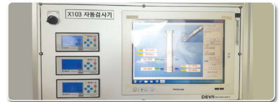
내경3포인트, 외경 2포인트 측정, 전용 측정 소프트웨어
