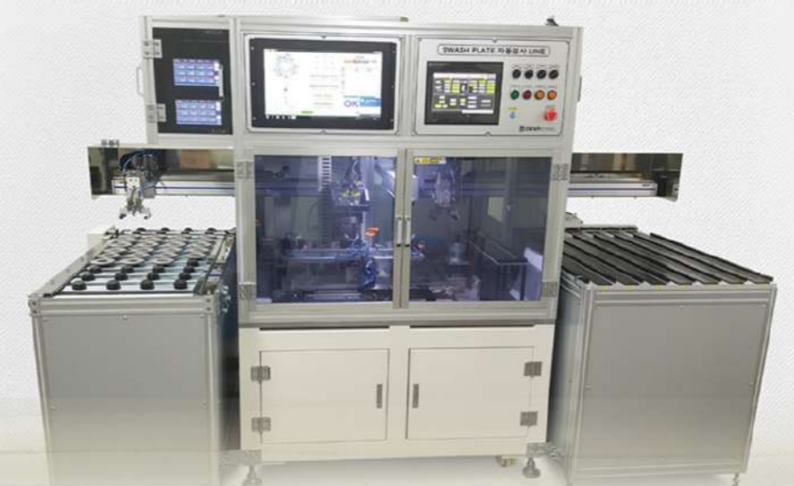
홀유무 두께 단차 전장 평면도 진직도 측정, 양품 레이저마킹, 전용 프로그램 제작
