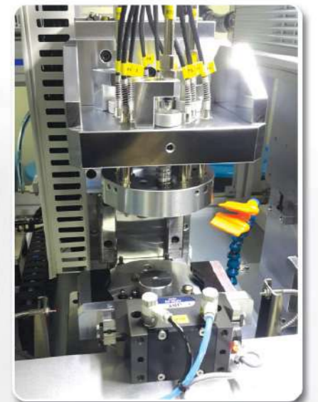
홀유무 두께 단차 전장 평면도 진직도 측정, 양품 레이저마킹, 전용 프로그램 제작
